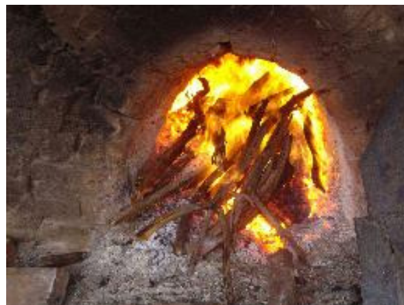
Figura 3 - Câmara de Combustão do forno caipira.
