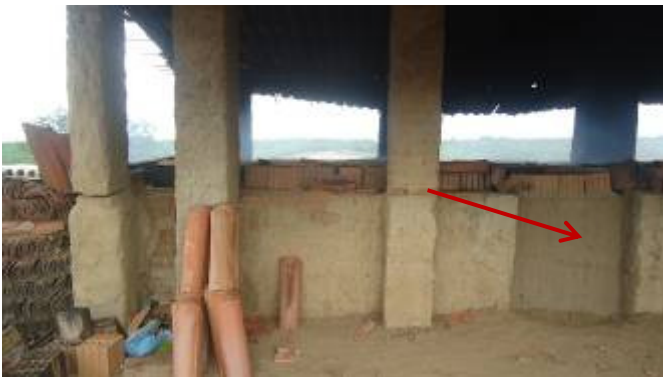
Figura 5 - Abertura indicada pela seta para carregamento do forno, fechada para a queima.
