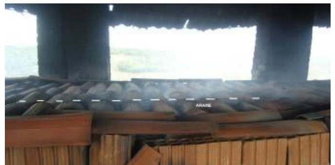
Figura 9 – Arame, sobre a carga enforada, utilizado como referência para controle do processo de queima.
